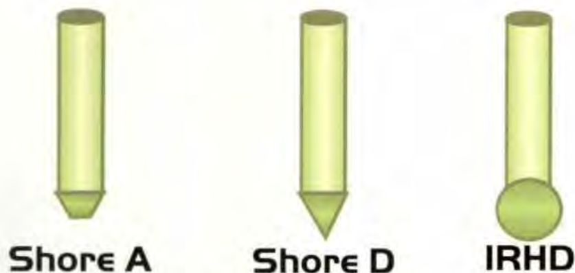
Figura 4. Diferentes tipos de indentadores.
