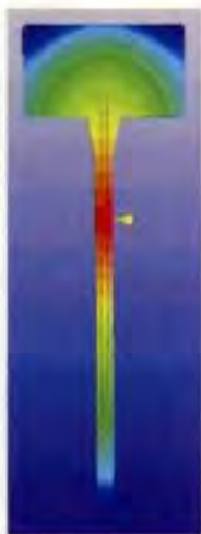
Figura No. 3 Simulación del mejor punto de inyección para la "Paleta de Anuncio"
