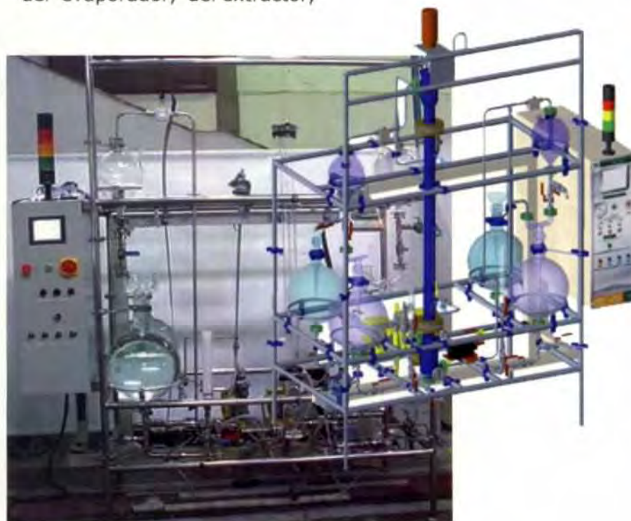
Figura 2. Planta de extracción Líquido-líquido
