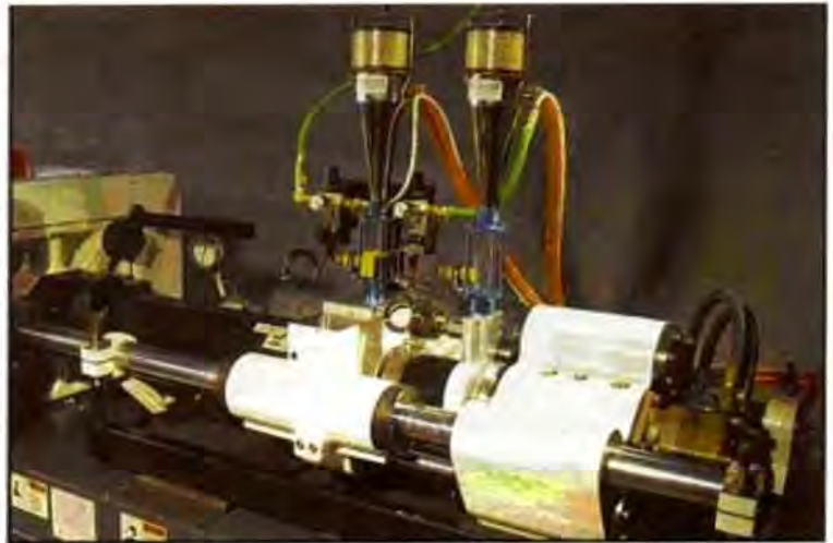
Figura 2. Máquina para co-inyección de un solo cilindro
