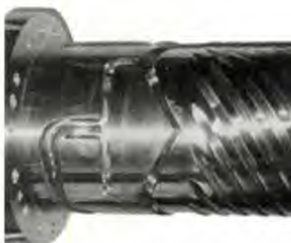
Figura 1. Vista exterior de un cabezal con distribuidor helicoidal para revestimientos, con alimentación lateral, prerramificación cuádruple y distribución previa tipo percha.
