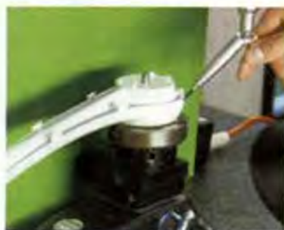
Figura 3. Palpador de punta viva en una aplicación de digitalizado
