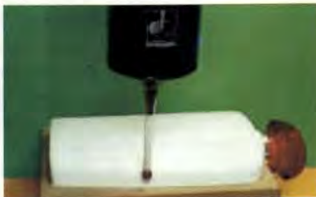
(b) Digitalizado con SAP de contacto continuo.
