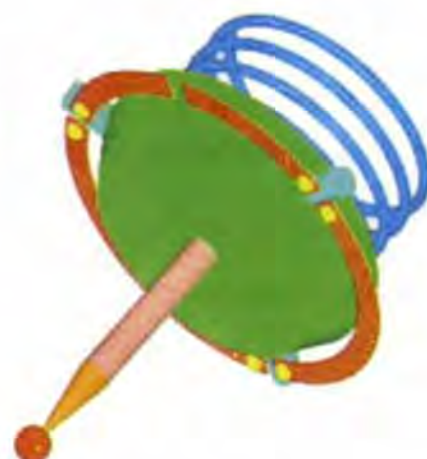
Figura 5. Esquema del principio básico de un sensor de contacto
