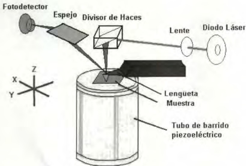
Figura 4. Esquema de un Microscopio de Fuerza Atómica (AFM) (3)
