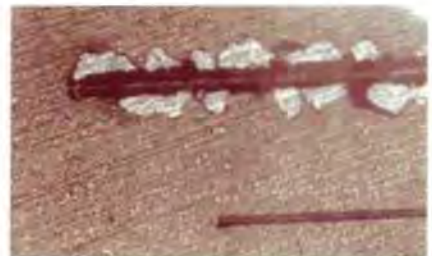
Figura 7. Prueba de rayado del TiN de la probeta 6M con cargas de 0.8 y 4 Kgf (x100)
