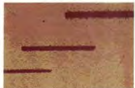
Figura 6. Prueba de rayado de la probeta 8M con 1, 2 y 4 Kgf (x100)
