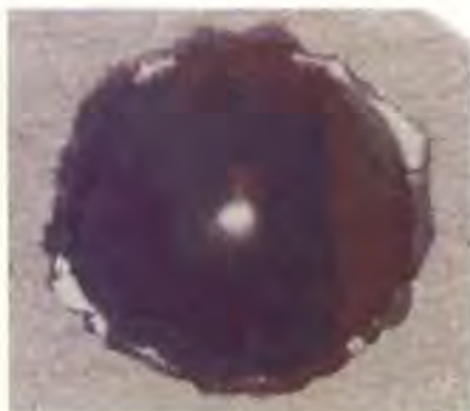
Figura 8. Adherencia del TiN de la probeta 8M mediante el método de Rockwell C (x50)
