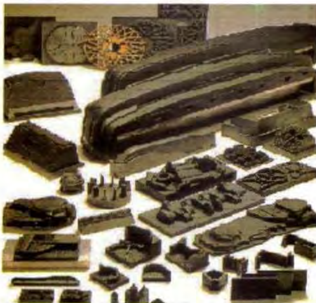
Figura 3. Diferentes electrodos para emplear en EDM
