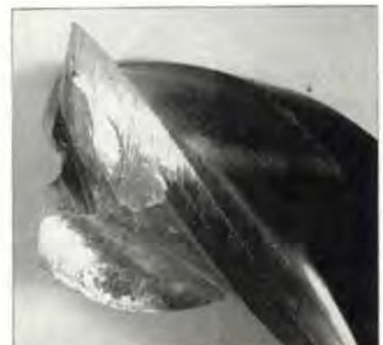
Figura 4c. Broca desgastada por adhesión de material [4]
