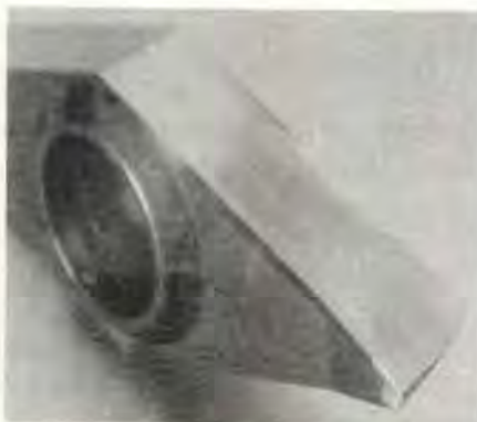
Figura 4a. Herramienta de corte recubierta con TiAlN
