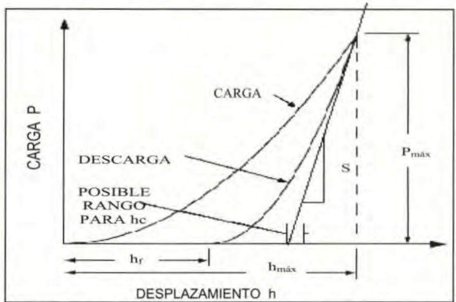
Figura 2. Representación esquemática de la información disponible en una curva Carga vs. Desplazamiento en un proceso de indentación
