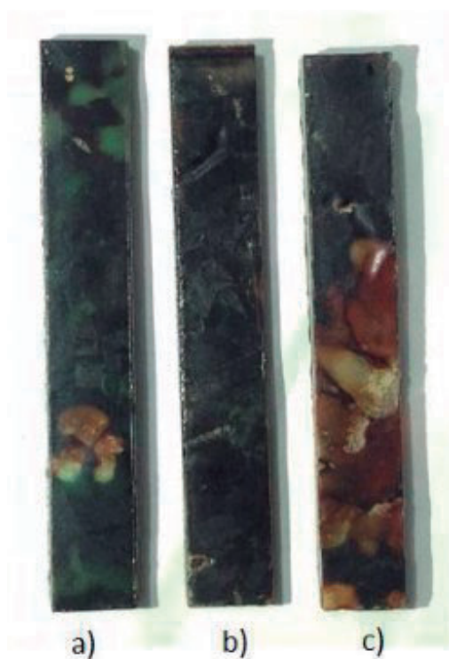
Figura 7. Muestras de las mezclas de PET: a) PA-PV, b) PA-PV-PT, c) PA-PT.
