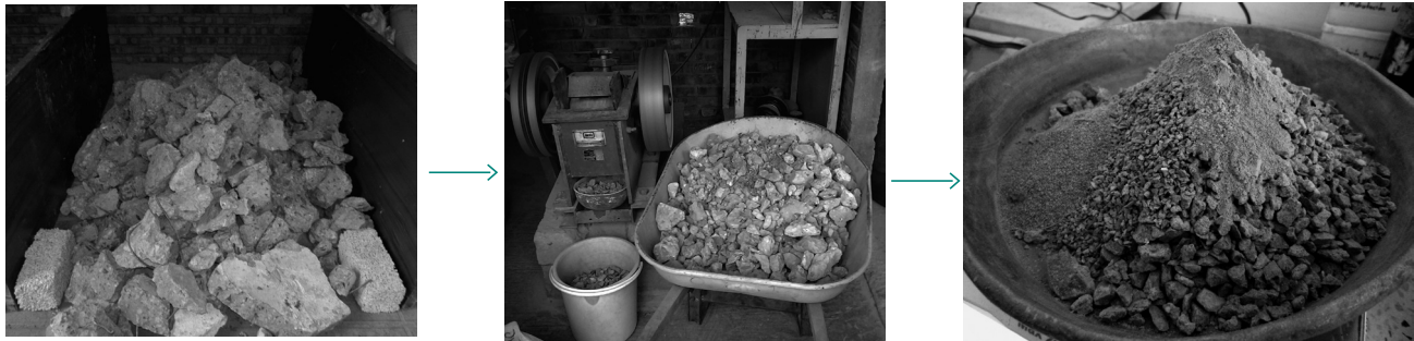
Figura 2. Proceso de trituración de los escombros.
