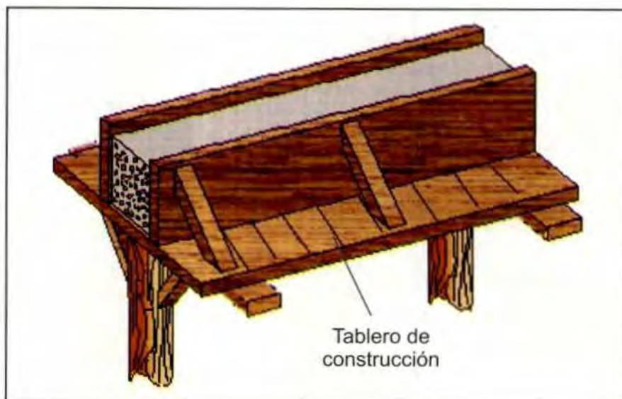
Figura 11. Formaletería de construcción
