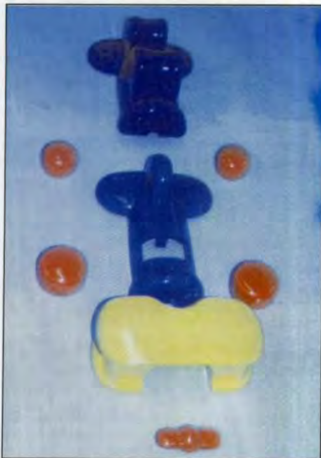
Figura 3. Componentes estereolitográficos pintados y ensamblados para producir un modelo de presentación del producto final - un avión de juguete
