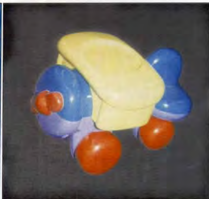
Figura 3. Componentes estereolitográficos pintados y ensamblados para producir un modelo de presentación del producto final - un avión de juguete
