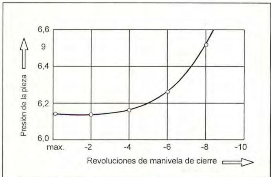
Figura 5. Aumento del peso al reducirse la fuerza de cierre
