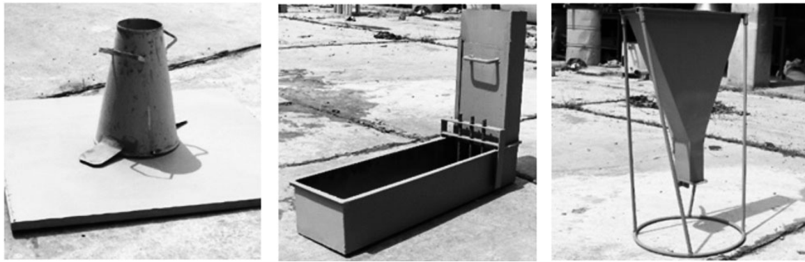
Figura 3. Ensayos realizados en estado fresco, Asentamiento (izquierda), Embudo en V (centro), y Caja en L (derecha).
