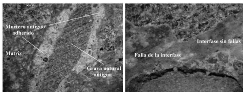
Figura 6. Zonas de interfase y falla después de la carga, Izquierda y derecha respectivamente.
