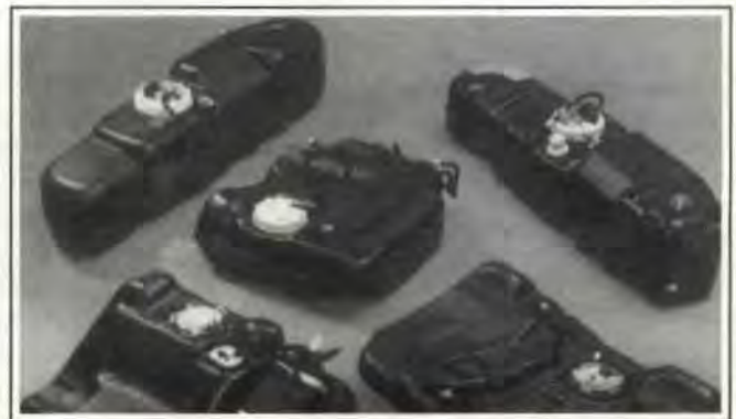
Figura 5. Depósitos de carburante de seis capas
