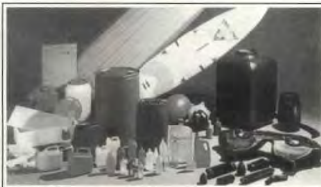
Figura 4. Artículos realizados mediante la tecnología de soplado
