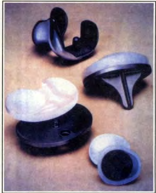
Figura 7b. Componentes de una prótesis total de rodilla. El plato tibial y la rótula se diseñan en UHMWPE por sus propiedades mecánicas en servicio y su comportamiento en fricción, desgaste y fatiga.
