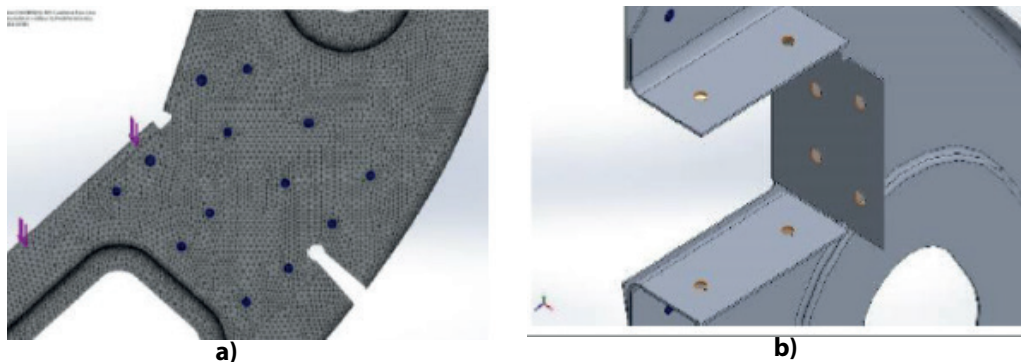
Figura 16. Conexiones y restricciones en la cuaderna: a) conector tipo pasador, b) sujeción fija
