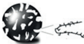
Figura 2. Estructura macroporosa de una matriz polimérica Fuente: elaboración propia.
