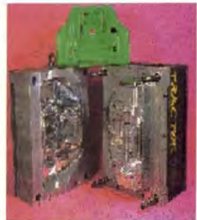
Figura 4. Ejemplo de molde prototipo mecanizado en aluminio
