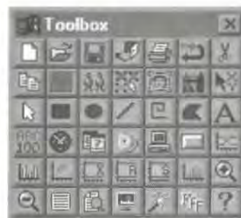
Figura 3. Caja de herramientas para edición gráfica de Intellution FIX.
