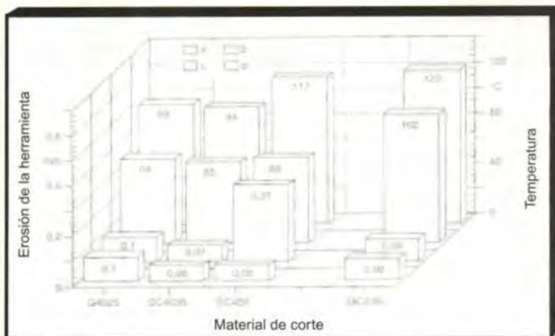
Figura 5. Comparación entre maquinado seco y húmedo al torneear C54, a) desgaste de la herramienta en el torneado húmedo b) en el torneado seco c) temperatura del inserto d) de la pieza
