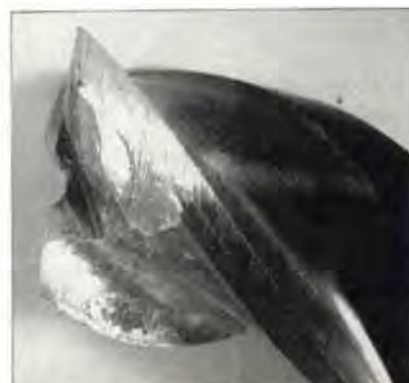
Figura 4c. Broca desgastada por adhesión de material [4]
