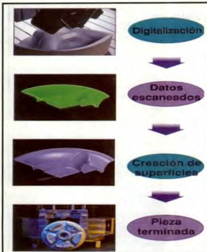
Figura 5. Sistema de digitalización láser (No contacto)
