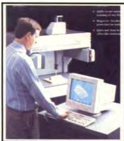
Figura 3. Sistema de digitalización de contacto
