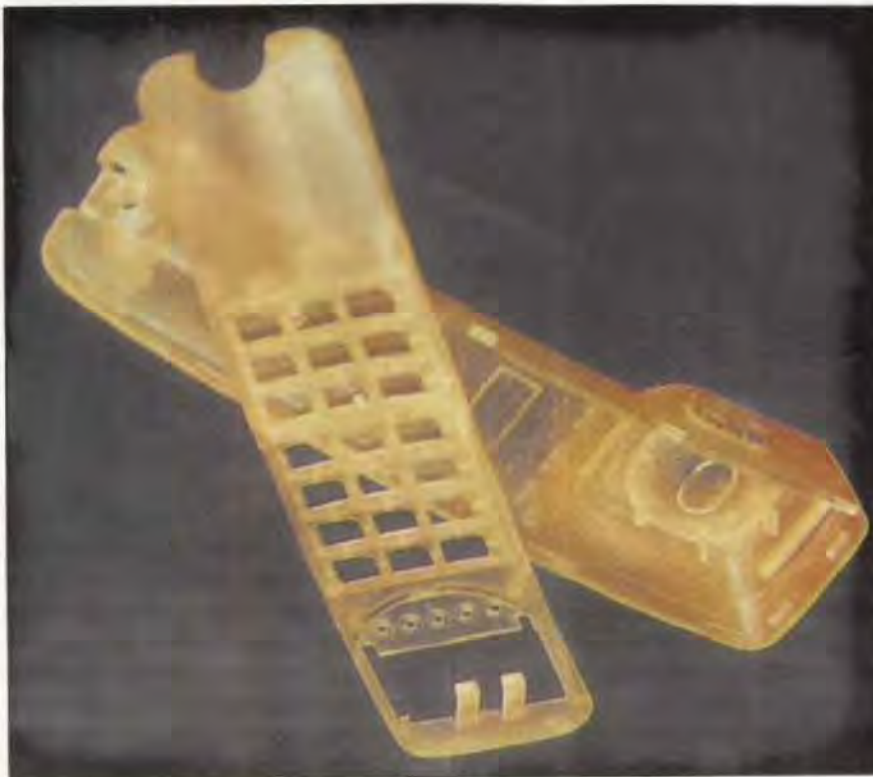
Figura 2. Modelos conceptuales, de una pieza de geometría compleja, una carcasa de teléfono.
