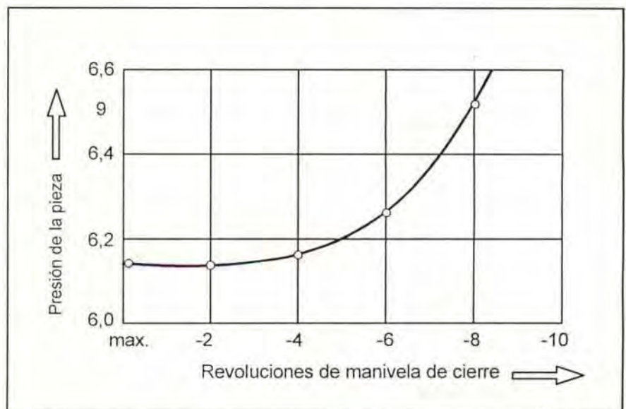
Figura 5. Aumento del peso al reducirse la fuerza de cierre
