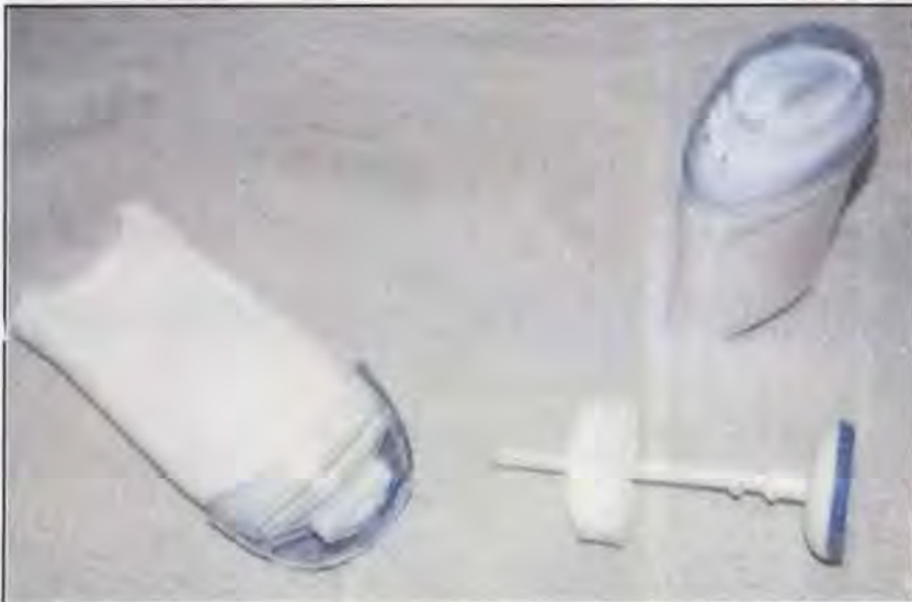
Figura 4. Moldes de caucho de silicona y prototipos de uretano de un empaque de cosméticos, fueron creados mediante el uso de patrones de prototipado rápido
