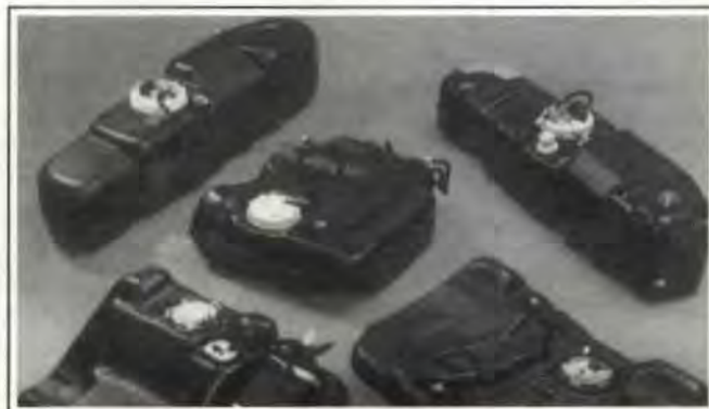
Figura 5. Depósitos de carburante de seis capas
