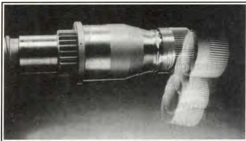
Figura 1. 4 millones de tapas roscadas más, en un año: núcleos giratorios con superficies de rozamiento recubiertas de WC/C aumentan la productividad y la calidad
