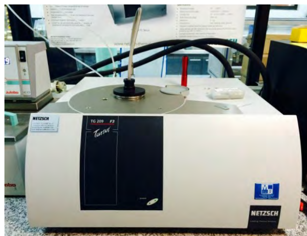
Figura 3. Equipo de análisis TGA-DTG
