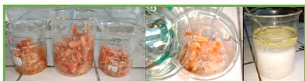
Figura 4. Obtención de quitosano a partir de exoesqueleto de camarón
