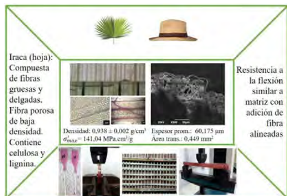
Fig. 1. Resultados de la caracterización de la adición de fibra de iraca en un sistema compuesto polimérico.
