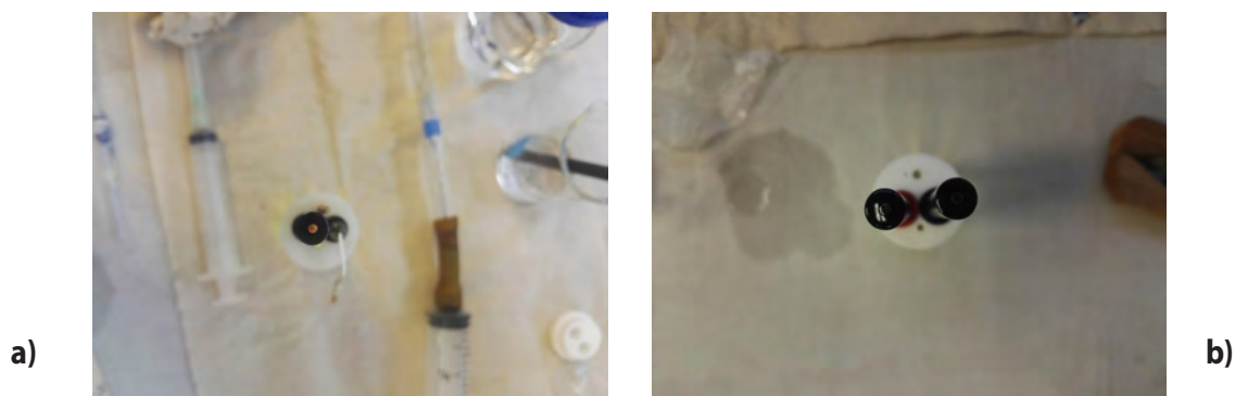
Figura 1. (a) Electrodo de oro sin recubrir. (b) Electrodo de oro recubierto con PPy-SURF-1 y PPy-SURF-2
