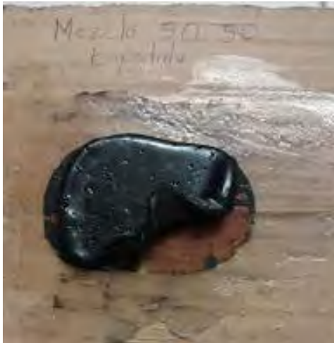
Figura 2. Imagen del sellante asfáltico depositado sobre la muestra de cartón recubierta con la mezcla EVA/parafina 50:50.
