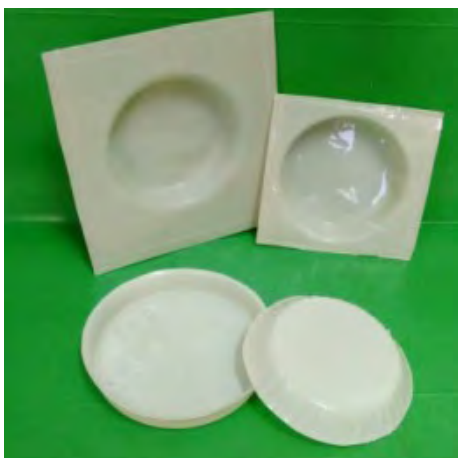
Figura 3. Productos termo formados a partir de las películas obtenidas
