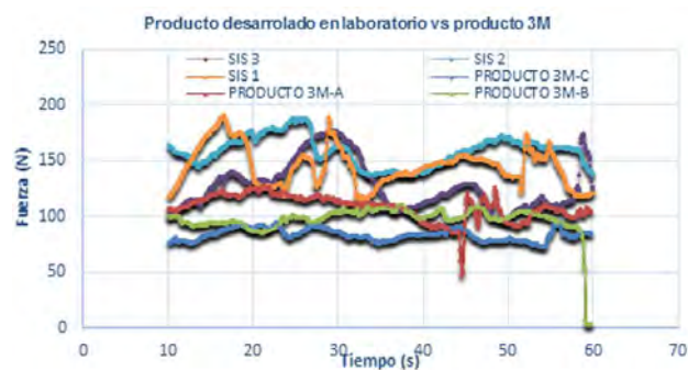
Figura 10. Resultados comparativos de resistencia al desgarre entre el producto desarrollado a escala laboratorio vs producto testigo indicado como 3M
