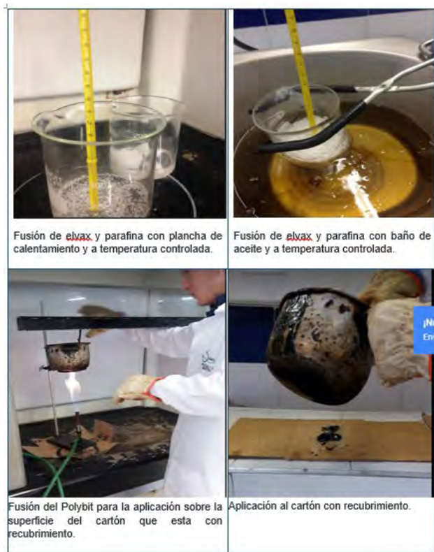
Figura 1. Imágenes del proceso de fabricación de los compuestos EVA/parafina
