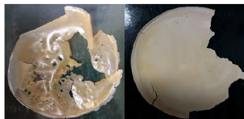
Figura 2. (Izq) P3HB extraído con ácido acético. (Der) P3HB extraído con cloroformo.
