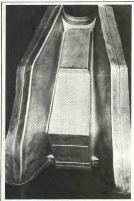
Figura 17. Matriz galvánica de níquel de sulfamato parcialmente reforzada por cobre
