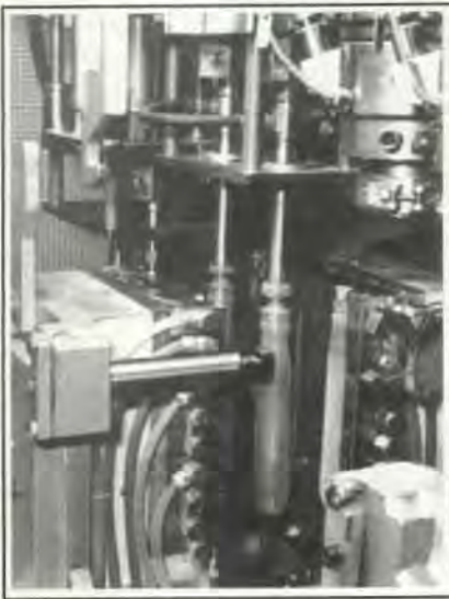
La tecnología BMO: premolde abierto con preforma
