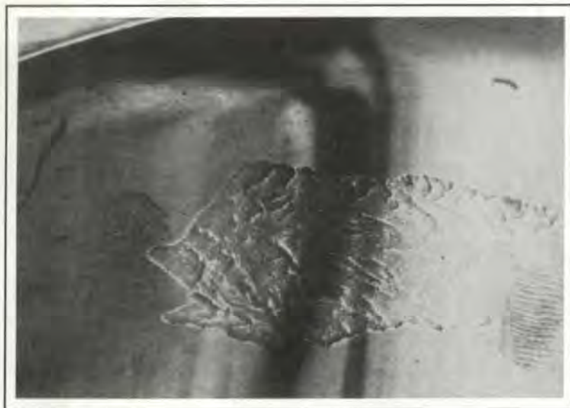
Figura 11. Desprendimientos de la capa nitrurada causados por fundido de PC en proceso de enfriamiento
