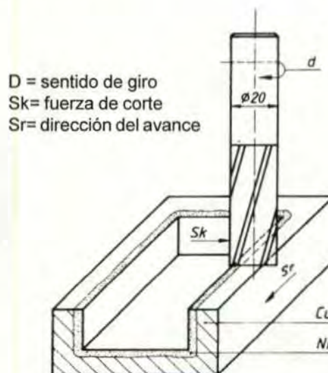
Figura 12. Movimientos del fresado
