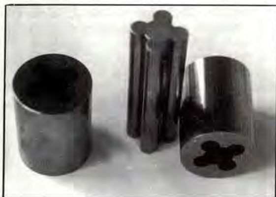
Figura 3. Matriz de compactación para fabricación de terrajas
