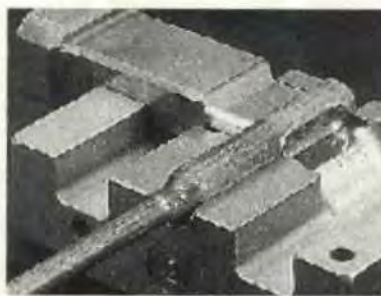
Fig. 7 Punzones combinados de corte y conformado para perforar los orificios de llantas de acero de automóvil
