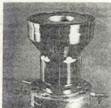
Gráfica 10. Portamandril con pieza de transición lisa
