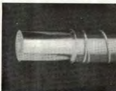
Fig. 7 Macho del molde con recubrimiento BALINIT fabricado en ISO 1.2344/ AISI H 13 para recipientes de rollos de películas.
