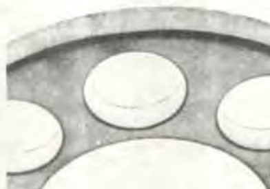
Fig. 7 Pieza de trabajo de troquelado de precisión, fabricada con útiles interiores recubiertos con Balinit y útiles exteriores sin recubrimiento.
