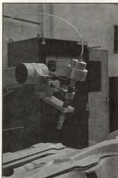
Figura 4. El útil para el corte con chorro de agua es, en esencia, una tobera con mando neumático.
