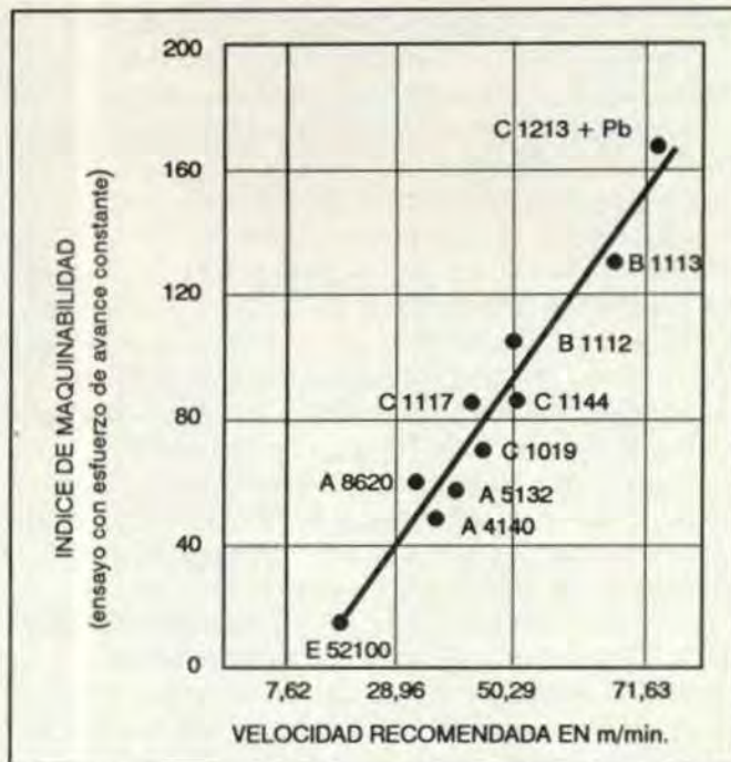
FIG. 5 Comparación entre las velocidades de corte comerciales y los resultados de los ensayos de corte con esfuerzo de avance constante [Battelle Memorial Institute (15)].
