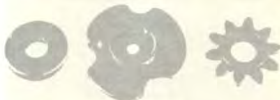
Gráfica B/10: Ruedita de diez dientes, fabricada por extrusión lateral.
