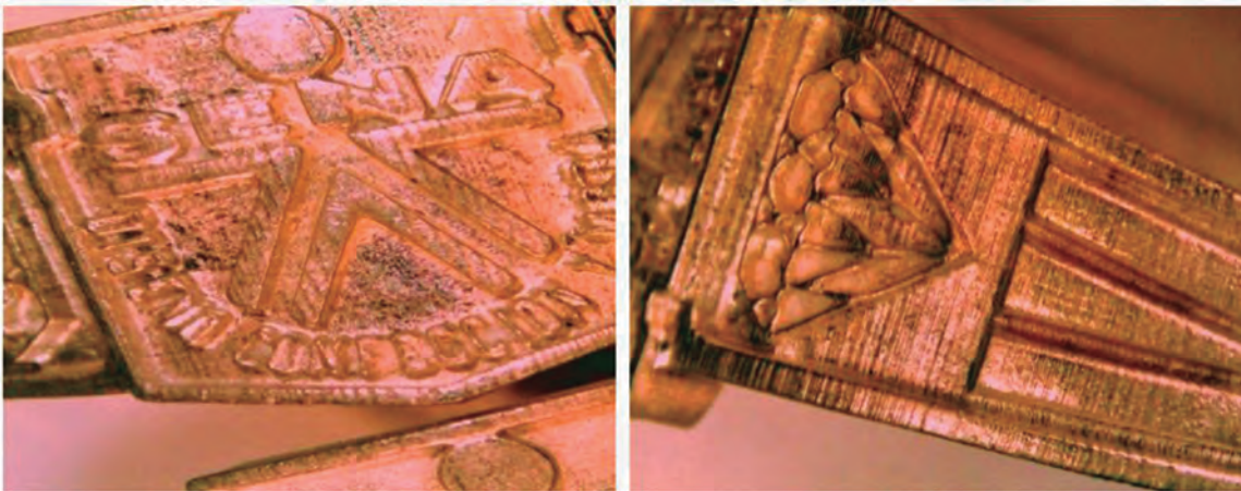
Figura 9. Detalles de la superficie de las piezas fundidas impresas con resina Epic 2000 bajo condiciones de quemado de Curva 2 Fuente: elaboración propia
