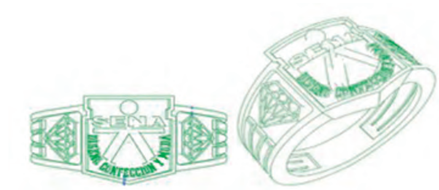
Figura 4. Modelo CAD del anillo para impresión 3D. Fuente: elaboración propia
