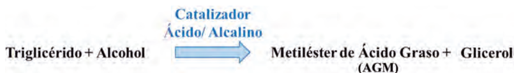
Figura 1. Reacción del proceso de Transesterificación Fuente: elaboración propia
