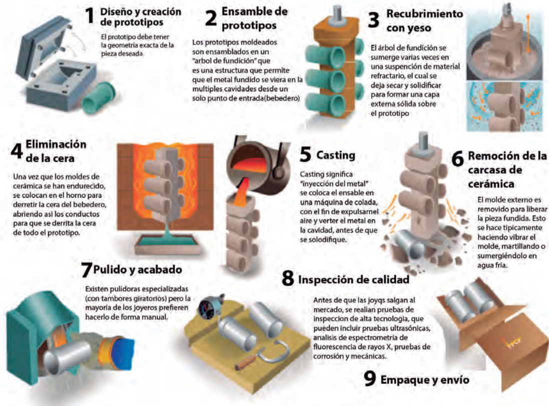
Figura 1. Etapas involucradas en la fabricación de joyas mediante el proceso de cera perdida. Fuente: adaptado de Pennsylvania Precision Cast Parts (PPCP)
