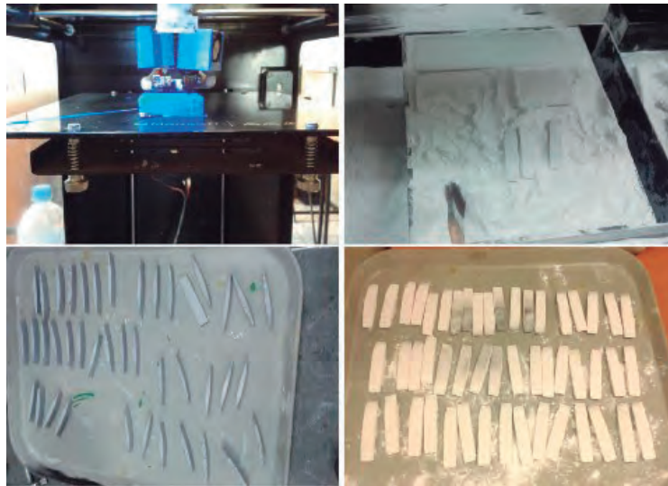
Figura 6. Impresión de álabes Fuente: elaboración propia
