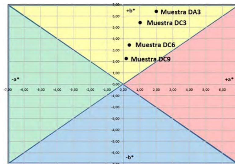
Figura 7. Representación del modelo de color CIELAB ( L^*a^*b^* ) para cada muestra estudiada. Fuente: Los autores.
