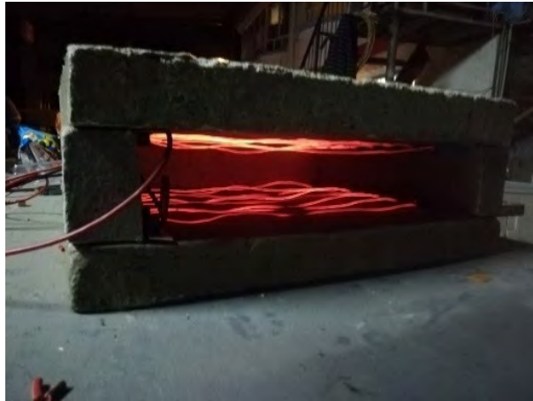
Figura 2. Prueba de capacidad de calentamiento del NICROMO Fuente: elaboración propia.
