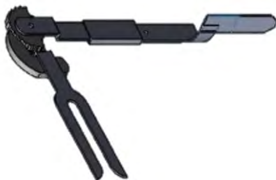
Figura 2. Mecanismo de trinquete y uñeta Fuente: elaboración propia
