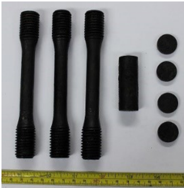
Figura 1. Probetas después de uno de los tratamientos térmicos de cementación.
