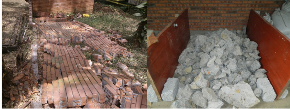
Figura 1. (a) Residuo de mampostería y (b) Residuo de concreto Fuente: elaboración propia.
