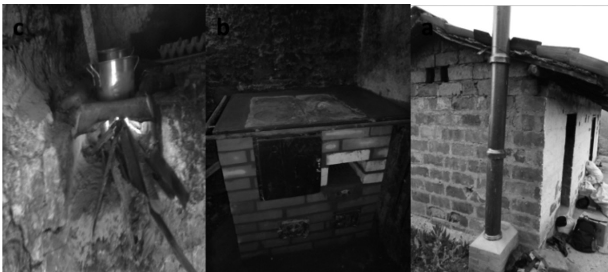
Figura 1. (a) Fogón tradicional (b) y estufa mejorada FN (c) con chimenea externa
