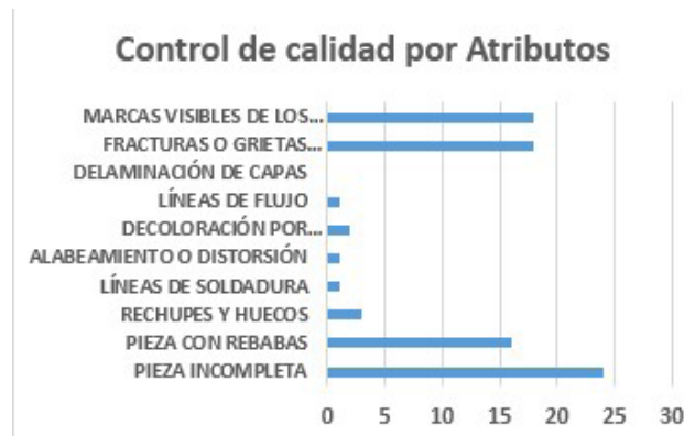
Figura 3. Control de calidad de las probetas inyectadas.
