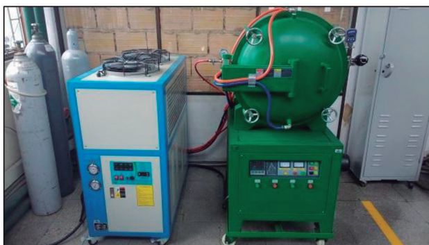
Figura 6. Horno eléctrico de sinterización PT-V1700 34L.
