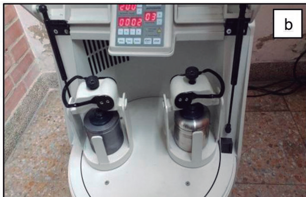
Figura 3. (a). Polvo cerámico y metálico dentro del recipiente (b) Molino planetario donde se realiza la mezcla y molienda del material en polvo
