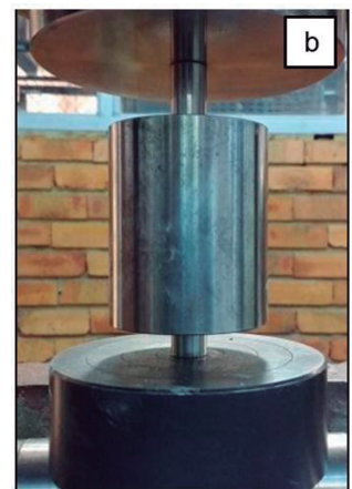
Figura 4. (a) Estado final de la mezcla tras el secado. (b) Muestra de polvo lista para compactación.
