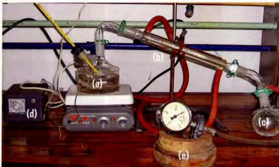
FIGURA 1. Equipo de destilación usado para polimerizar el ácido láctico: El montaje consta de: a) Un balón de dos bocas donde se introduce el ácido láctico, b) un condensador que permite el flujo de agua para eliminar el subproducto, c) un balón de una boca donde se deposita el agua eliminada, d) un controlador de temperatura y e) un equipo para reducir la presión y cuantificarla.
