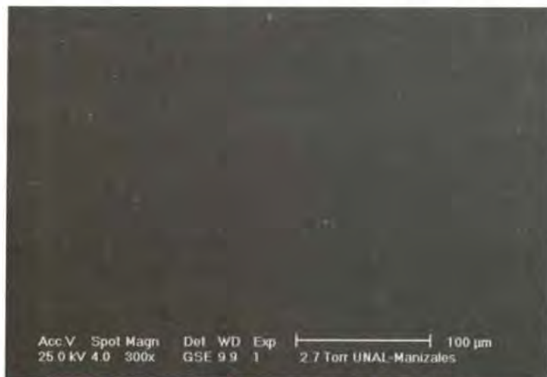
Figura 10. La imagen SEM muestra la morfología de una película de BN crecida con voltaje de polarización -120\text{V} r.f.
