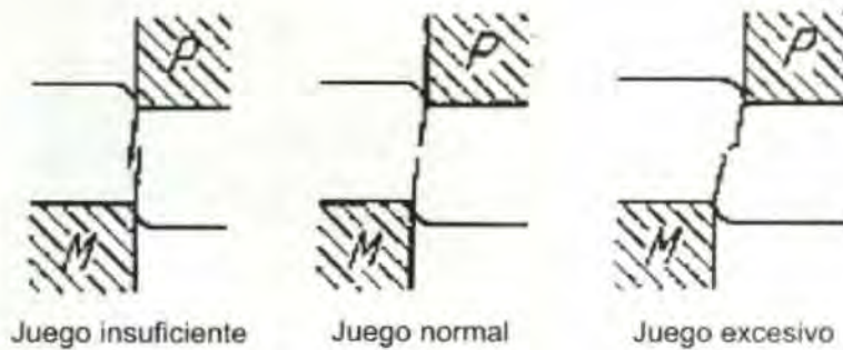
Figura 4. Posición relativa de las grietas según el juego
