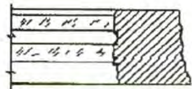
Figura 5b. Características del borde con juego insuficiente
