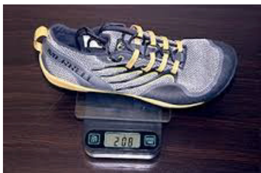
Figura 3. Ejemplo de medición de peso de zapato.
