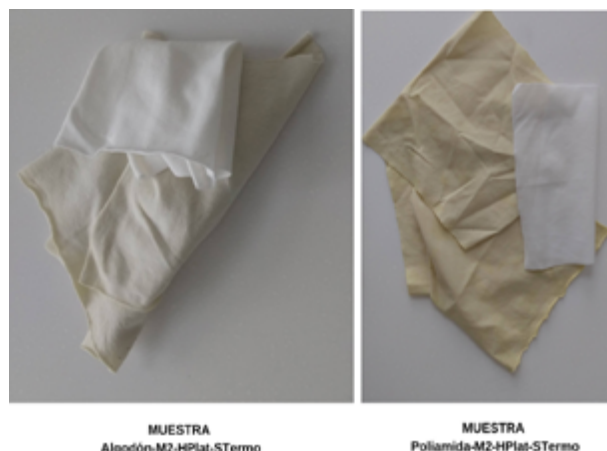
Figura 4 Algodón y poliamida teñidos con colorante extraído de hoja de plátano y tratados con mordiente de Piedra alumbre (KAl(SO 4 ) 2 12H 2 O) y Cloruro de sodio
