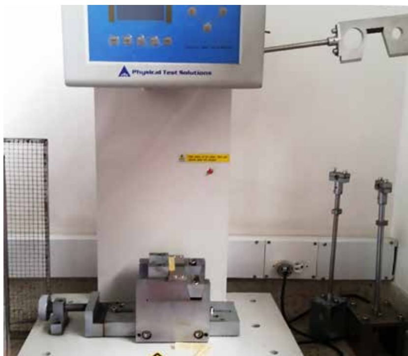
Figura 5. Máquina de prueba para impacto (Autoría propia).
