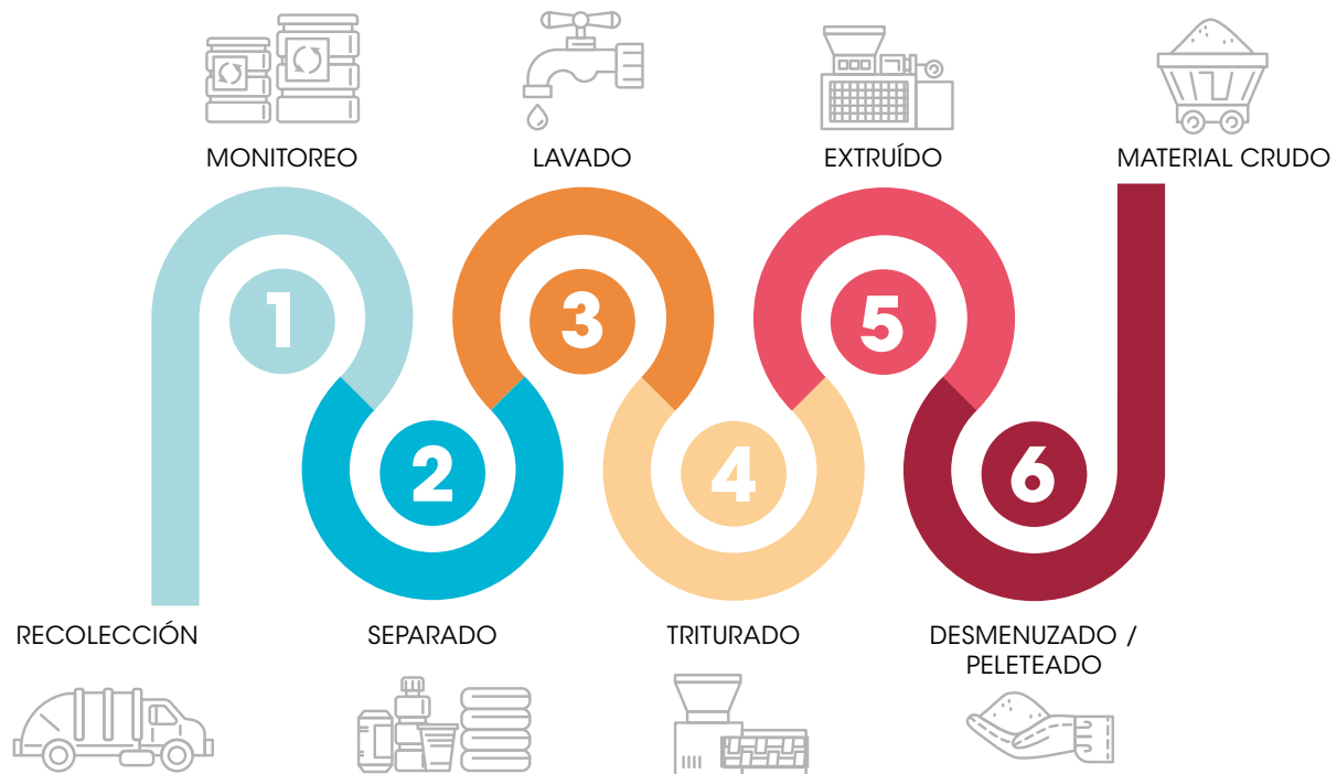
Figura 3. Representación esquemática del proceso de reciclaje mecánico de polímeros. Basado en K.Bhanderi, et al. 2023.
