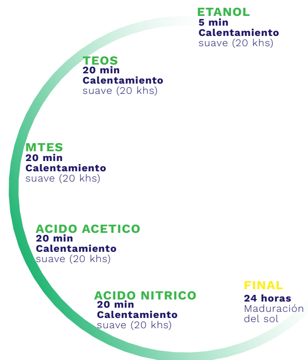
Figura 7. Preparación sol-gel
