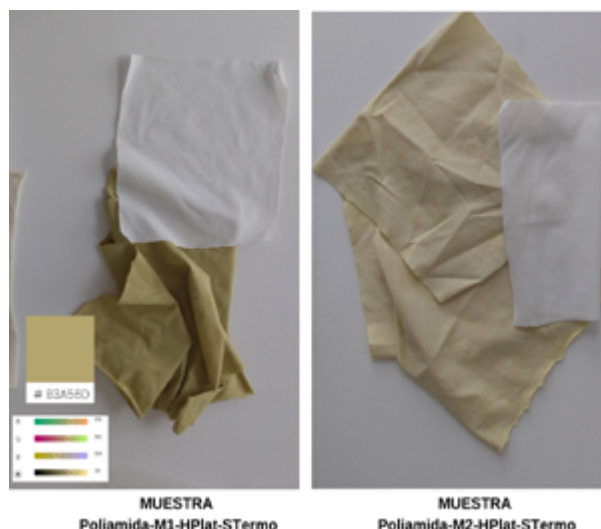
Figura 3 Muestras de poliamida teñidas con hoja de plátano utilizando mordiente M1 (Sulfato de cobre + Cloruro de sodio + Jugo de limón) y M2 Piedra alumbre (KAl(SO 4 ) 2 12H 2 O) + Cloruro de sodio.
