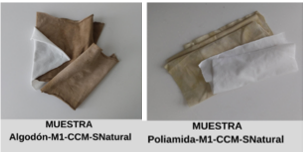
Figura 8 Muestras de algodón y poliamida teñidas con colorante natural de cáscara de cebolla morada.
